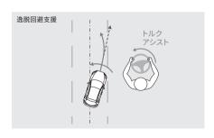
車線逸脱を制御する/車線に沿った走行をアシストする レーンキープ・アシスト・システム(IAS)\*1\*4
