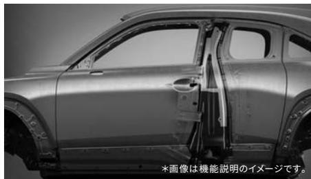
フリースタイルドアを採用するMX-30では、リアドア内部に配置した強固な補強部材をはじめとするさまざまな工夫によって高い衝突安全性能を実現。側面衝突に対しても効率的にエネルギーを吸収・分散し、キャビンの変形を最小限に抑えます。
