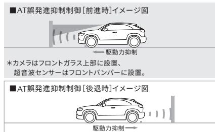
ペダルの誤操作による急発進を抑制する
