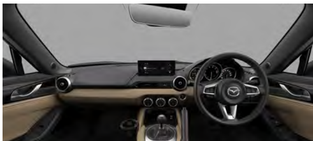
エンジンスタータースイッチリング・オートエアコンスイッチ リング(サテンクロームメッキ)/エアコンルーバー加飾 外側/内側(サテンクロームメッキ/ブラック)/ Boseサウンドシステム(AUDIOPILOT2) +9スピーカー/フレームレスインナーミラー/ センターコンソール表皮巻(合成皮革)
