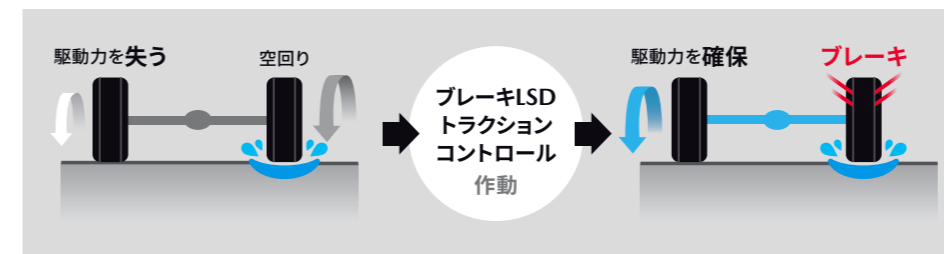
*システムがタイヤの空回りを検知すると自動で作動します。
