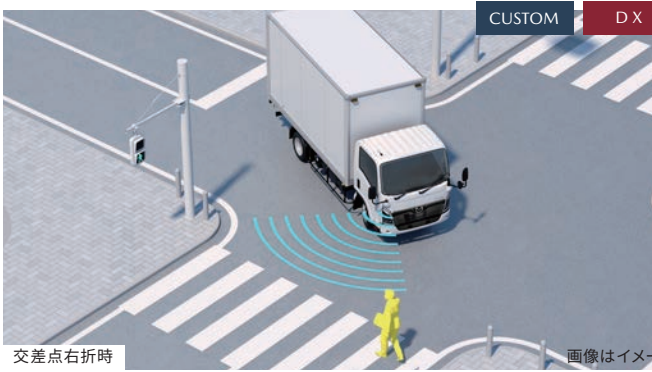
車両前方死角エリアの物体を検知し警告 ブラインドスポットモニター (交差点警報・出会い頭警報) ヘッドランプ上部2箇所に広角のミリ波レーダーを配し死角エリアの自動車/バイク/自転車/歩行者などを検知してドライバーに警報とピラー部の警告灯で警告。交差点での右左折時や出会い頭などの事故抑制に貢献します。 *【交差点右左折時】自車速：約4～22km/h 警報対象速度：約5～20km/h 警報対象：歩行者/自転車で作動します。 *【交差点での出会い頭】自車速：約0～10km/h 警報対象速度：約20～60km/h 警報対象：自動車/バイクで作動します。
