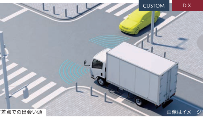
夜でも横断中の歩行者を検知 プリクラッシュブレーキ (衝突回避支援/衝突被害軽減) 衝突の危険性が高まると警報および緊急ブレーキで衝突回避や被害軽減に貢献。昼夜を問わず、車両、歩行者、自転車を鋭く検知します。 *自車速度が約10km/h以上で走行中、先行車両との相対速度が約50km/h以内で衝突回避を支援。相対速度が約50km/hを超える場合は衝突被害を軽減します。また、道路状況、天候状態、運転操作等によっては作動しない場合があります。
