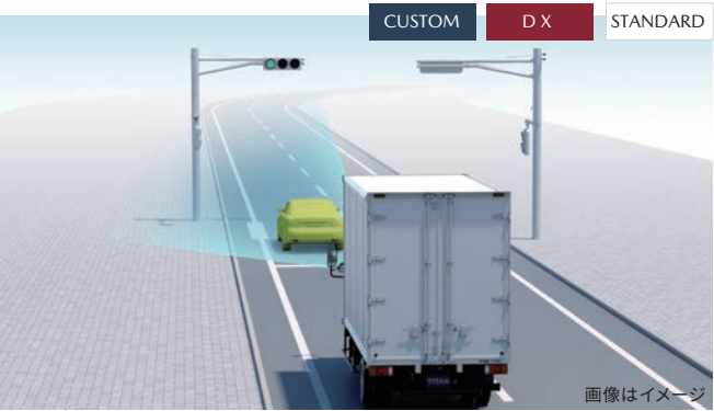
信号待ちなどの出遅れ防止に 先行車発進お知らせ機能 先行車に追従して停止後、先行車が発進しても自車の発進操作がなかった場合、警報音で注意を喚起。再発進時の出遅れ防止に貢献します。
