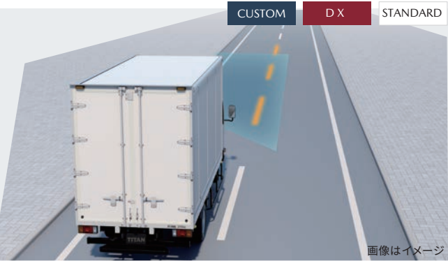
ふらつき等による、接触事故防止に貢献 車線逸脱警報 (LDWS) 走行中、カメラが車線を認識し、車両が車線から逸脱したとシステムが判断した場合、警報音で注意を喚起。接触事故の防止に貢献します。 *自車速60km/h以上で作動します。
