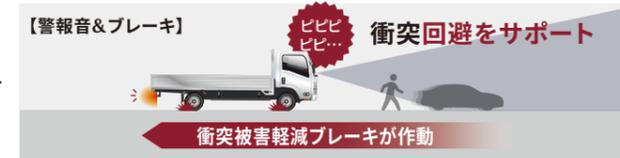
衝突被害軽減機能 相対速度が大きいとき ▶ 走行状態を検知し、衝突時の被害を軽減
