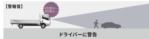
危険回避が行われず追突が避けられないと判断すると、衝突被害軽減ブレーキが作動し追突被害を軽減。
