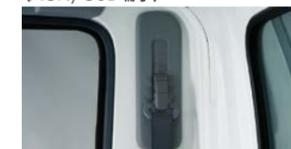
シートベルト アンカーアジャスター(運転席、4段階調整機構付)
