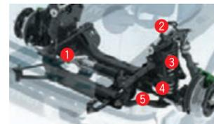
左右の車輪がそれぞれ独立して衝撃を吸収するサスペンションシステムです。ロワーアームとフレームの間のコイルスプリングとショックアブソーバーの働きでナチュラルな減衰特性を発揮。抜群の走行安定性と快適な乗り心地を実現します。
