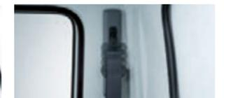
●シートベルト アンカーアジャスター(運転席、4段階調整機構付)
