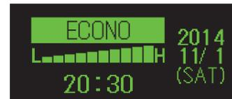
メンテナンスインジケータの表示項目に加え、走行中の省燃費運転状態や総合燃費、電圧など、より豊富な情報を液晶で表示します。
