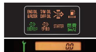
メーターパネル中央部で各種メンテナンス情報を表示し、距離計部に区間燃費やDPD堆積量、整備までの残距離を表示します。区間燃費や様々なメンテナンス情報が一目で確認でき、燃費の管理や効率的な整備に役立ちます。
