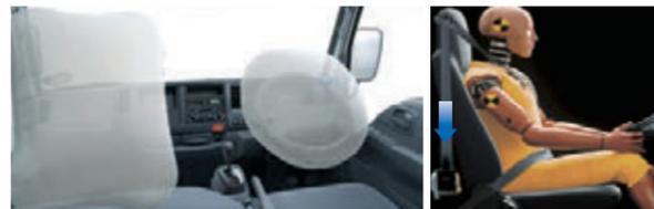
SRSエアバッグ&プリテンショナー付シートベルトを、運転席に全車標準装備。衝撃吸収に配慮したキャビンと合わせ、乗務員の安全確保とダメージ軽減に、システムで対応します。また、乗員保護の開発理念から、助手席側にもSRSエアバッグ&プリテンショナー付シートベルトを標準装備。ドライバーだけでなく、同乗者の安全性にも配慮しました。\*中央席は2点式
