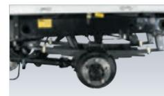
後軸への荷重をガッシリと支える剛性・耐久性にすぐれたサスペンション。積車時の走行安定性を確保し、空車時の振動を吸収します。
