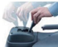
例えば平坦路は自動変速モードでクルージング、加速をしたい時や急な登坂路では手動変速にするといったように、状況に応じて変速モードが切り替えられます。
