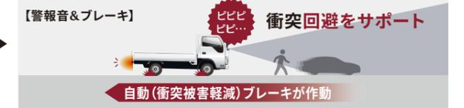
**衝突被害軽減機能** 相対速度が大きいとき ▶ 走行状態を検知し、衝突時の被害を軽減
