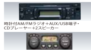
フルオートエアコン
