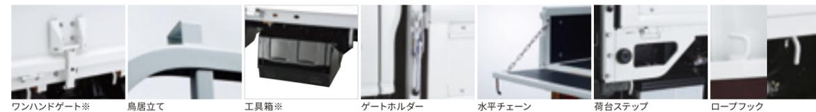
ワンハンドゲート※ 鳥居立て (ハイキャブ/ワイドキャブ) 工具箱※ ゲートホルダー 水平チェーン 荷台ステップ ロープフック
