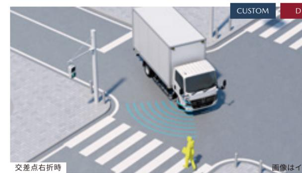
車両前方死角エリアの物体を検知し警告
