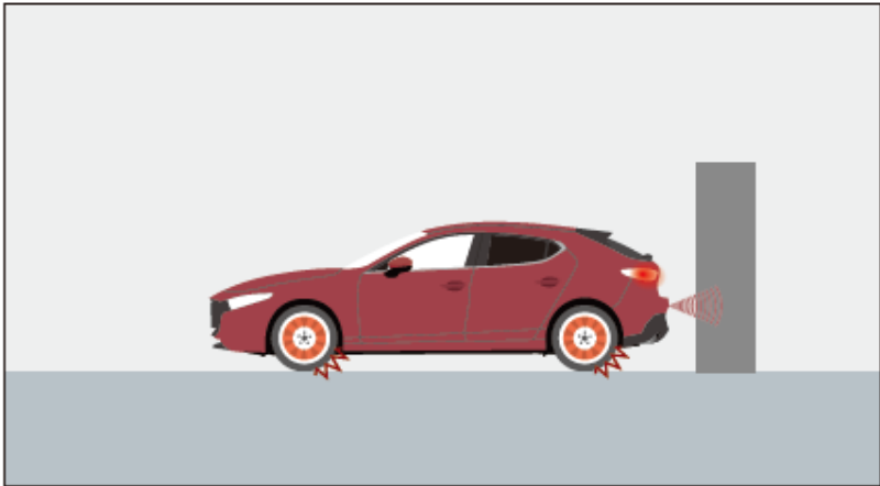
障害物に近づいても運転者がブレーキ操作を行わず、衝突を回避できないと判断したときは、衝突被害軽減ブレーキを作動させます。
